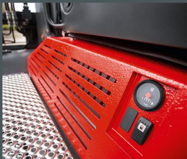
Die zentrale Serviceklappe, mit ihrem Zugang für Motorölstand, Luftfilter, Dieselfilter und vieles mehr, erleichtert die tägliche Durchsicht und garantiert eine maximale Verfügbarkeit.
