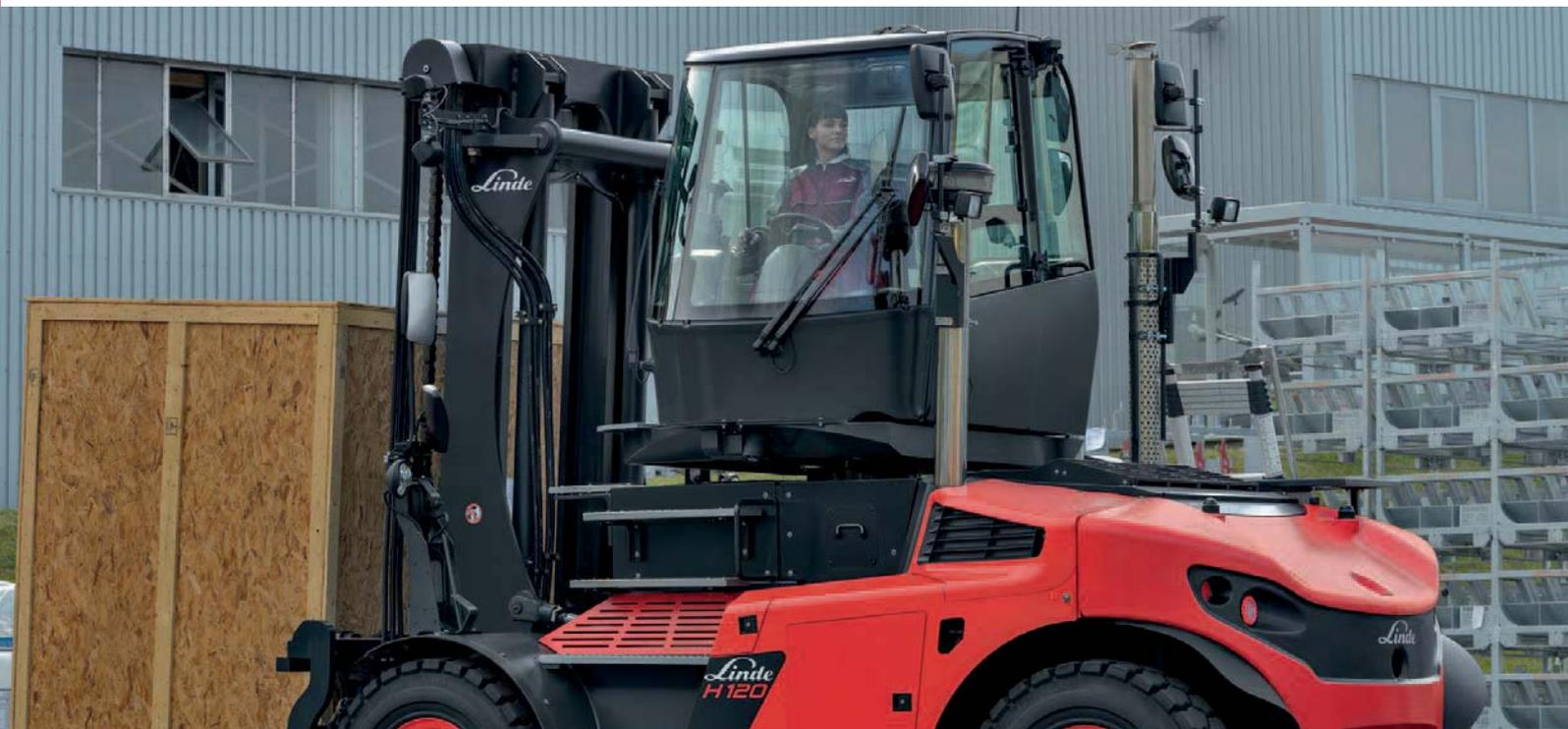
Mit der Drehkabine hat der Fahrer immer eine optimale Rundumsicht. Die gegenüber dem Standardmodell um 600 Millimeter erhöhte Kabine kann stufenlos über Joystick beziehungsweise per Positionsschalter um bis zu 180 Grad nach links oder 65 Grad nach rechts gedreht werden.
