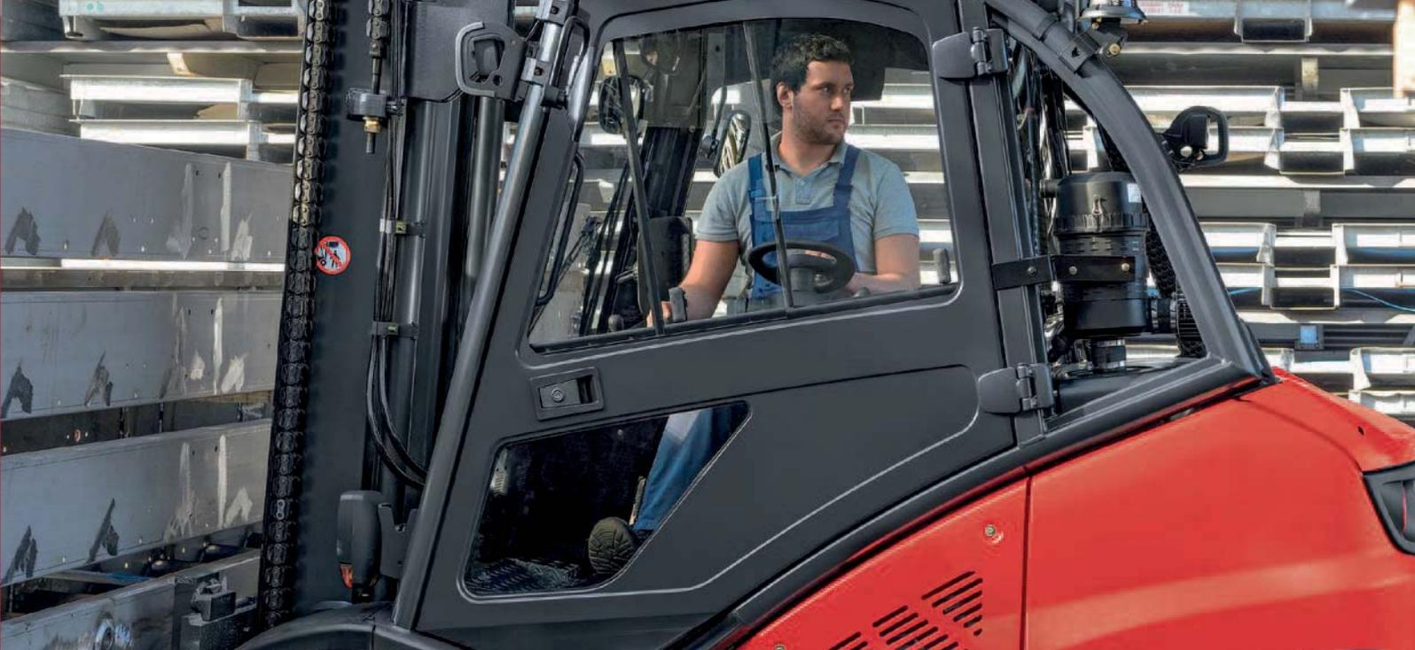
Die Bedienung des drehbaren Fahrerarbeitsplatzes ist einfach und intuitiv. Mit einem Handgriff wird der gesamte Arbeitsplatz inklusive des Sitzes mit Bedieneinheit, Lenkrad und Pedalen in die gewünschte Position gebracht. Zudem lässt sich der drehbare Fahrerarbeitsplatz auch in Zwischenstufen schwenken.
