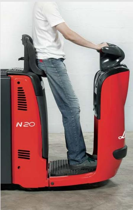
**Einstieg und Standplattform** Der 390 mm breite Eintritt an beiden Seiten und die niedrige Tritthöhe von 120 mm gewährleisten leichten Einstieg. Das Fehlen scharfer Kanten und Leisten steigert Sicherheit und Komfort für den Bediener.
