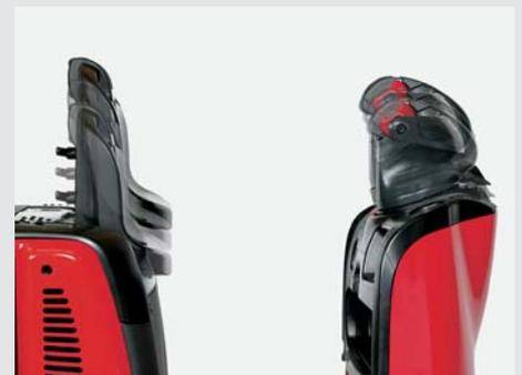
**Rückenlehne** Die Rückenlehne und optionale Höhenverstellung des Lenkers um 50 mm ermöglichen die Anpassung an die Körpergröße jeden Fahrers, der damit auf langen Transportstrecken und bei Kurvenfahrt hervorragend gestützt wird.
