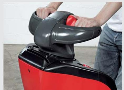
**Lenker** Am Linde Lenker sind alle Bedienelemente im direkten Griffbereich sowohl der linken wie auch der rechten Hand angeordnet, wodurch echte Einhandbedienung möglich ist. Serienmäßig ist das Fahrzeug mit leicht zu bedienender Servolenkung ausgestattet. Die positive Rückmeldung des Lenkwiderstands führt zu erhöhter Leistung bei Geradeausfahrt (80 % des Kommissionerzyklus) und hilft, das Fahrzeug genau in der Spur zu halten.
