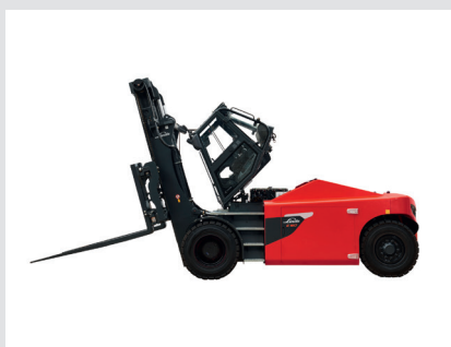
Servicezugang durch kippbare Kabine
