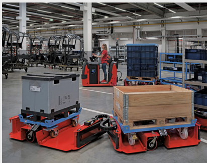
Minimaler Wenderadius mit sechs Rahmen dank Scheren-Zugstange
