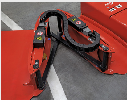
Einfache mechanische Konstruktion und wartungsfreie Energiekette
