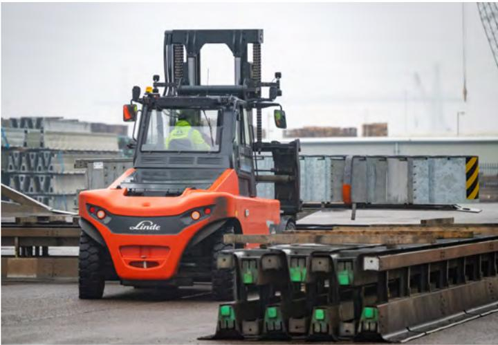
**So geht es sicherer** Der Linde E160 verfügt über ein speziell geformtes Gegengewicht, wodurch die Sicht auf den Bereich hinter dem Fahrzeug maßgeblich verbessert wird.
