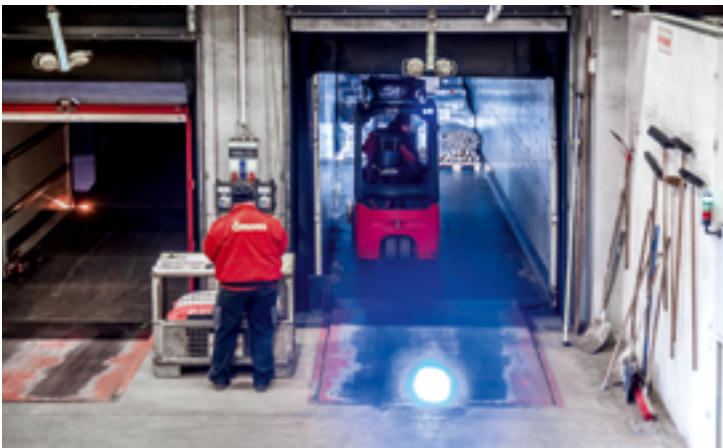
Umschlagsmeister – Die Linde E16 ermöglichen dank der Doppelpedalsteuerung präzises Lasthandling auf engstem Raum.
