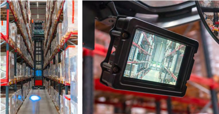
Durch die Active Stability Control in den Linde K-Modular sparte man sich bei K2 Systems die Installation eines Bodens nach VDMA-Norm, was rund um die Hälfte günstiger kam. Zusätzlich verfügen die Hochregalkommissionierer etwa über die Dynamic Reach Control sowie den Gangsicherheitsassistenten.
