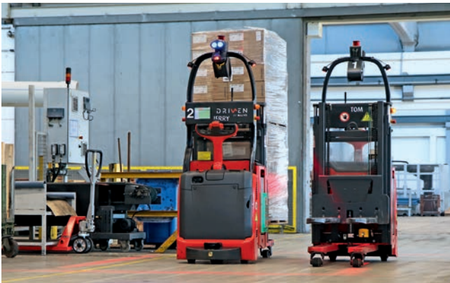
Langstreckenläufer – zwei Linde L-MATIC Hochhubwagen mit Geo-Navigation sorgen bei der Poloplast GmbH & Co. KG für reibungslose Warentransporte.
