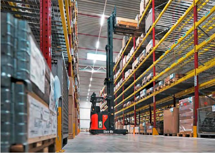
Dank einer innovativen 3D-Kamera können die Linde R-MATIC Schubmaststapler Lasten selbst in großen Höhen von bis zu elf Metern ebenso präzise wie effizient ein- und auslagern.
