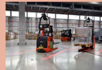
**Warnlinien:** LEDs projizieren seitlich des Fahrzeugs deutlich sichtbare Linien auf den Boden. Auf diese Weise haben vor allem Fußgänger eine Vorstellung vom Arbeitsbereich des Fahrzeugs
