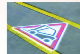
→ Die optische Warnsignallösung **TruckSpot** kündigt ein rückwärtsfahrendes Fahrzeug durch die Projektion eines großen Gefahrenzeichens auf dem Boden hinter dem Fahrzeug an.
