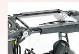
→ **Das Fehlen der A-Säule und ein Panoramadach aus Panzerglas** ermöglichen eine maximale Rundumsicht.
