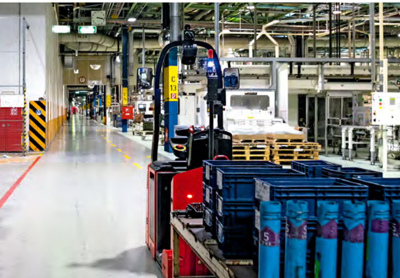
Sicher, flexibel, unkompliziert Der mit verschiedenen Sicherheitssystemen ausgestattete Linde-Routenzug navigiert dank einer virtuellen Landkarte präzise ans jeweilige Ziel.
