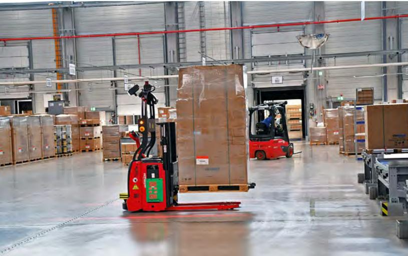
**Freie Wege, maximale Sicherheit** Da die autonomen Linde-Geräte in einem stark frequentierten Bereich arbeiten, projizieren sie unter anderem rote Warnstreifen seitlich auf den Boden.
