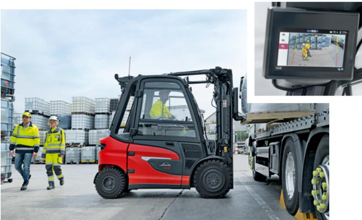
Alle elf Linde-Gegengewichtsstapler in Salzkotten sind inzwischen um die Linde Reverse Assist® Camera inklusive Zusatz-Display ergänzt worden. Praktisch: Bei der aktuellsten Stapler-Generation lässt sich das Kamerabild unmittelbar auf dem werksseitig verfügbaren 7-Zoll-Bildschirm anzeigen (siehe oben).
