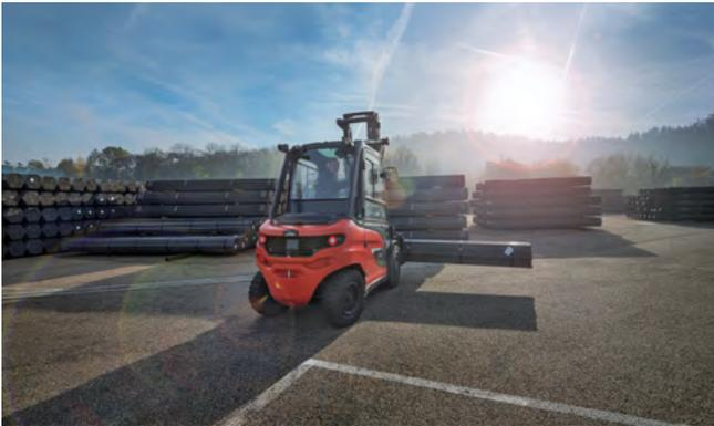
Schon wenige Zwischenladestopps genügen, um bei Layher trotz der hohen Leistungsintensität mit dem Linde X50 über zwei Schichten zu kommen. Aktuell plant das Unternehmen an einem neuen Standort bereits den Aufbau einer kompletten X-Stapler-Flotte.
