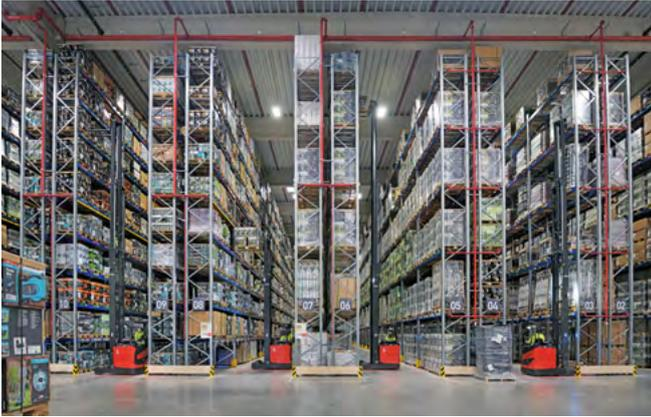
Optimale Technologie für optimale Raumausnutzung: Dank der Linde R20 mit Dynamic Mast Control klappt das Ein- und Auslagern selbst in 13 Metern Höhe nahezu schwingungsfrei; dem Unternehmen beschert das einen zählbaren Produktivitätsvorteil, der sich bei der enormen Anzahl an Vorgängen schnell summiert.
